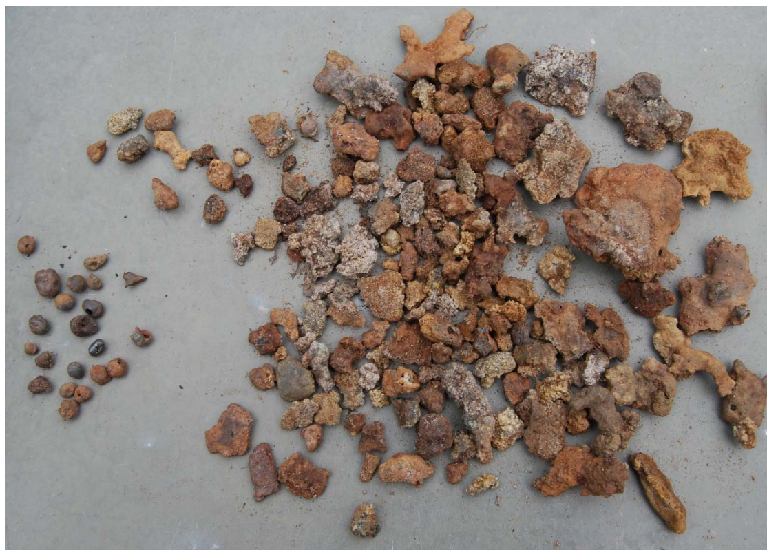
Fig. 11. Foto på den slagg som framkom i ruta X 1028/ Y 224. De större fragmenten till höger är från bottenkällor och kulorna till vänster är droppformig slagg.
